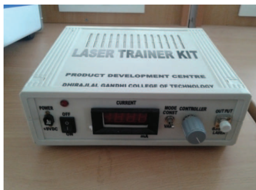
Fig 4. LASER Trainer kit module
